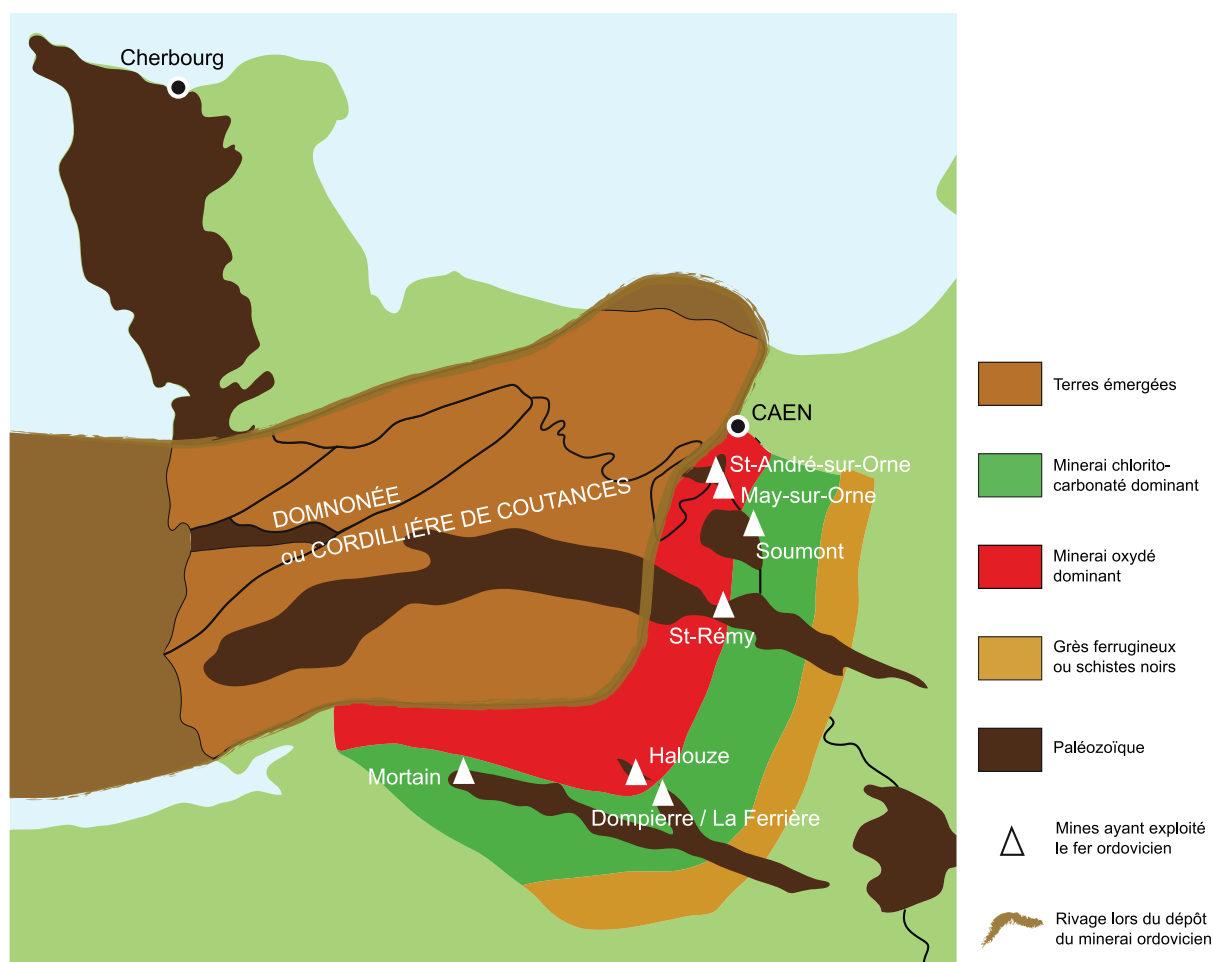
Fig. 3 – Reconstitution de la géographie des dépôts du minerai de fer vers - 460 millions d'années (Ordovicien, Paléozoïque). Dessin d'origine (Le Gall et al. , 2003) d'après Doré (1969) et Joseph (1982).
