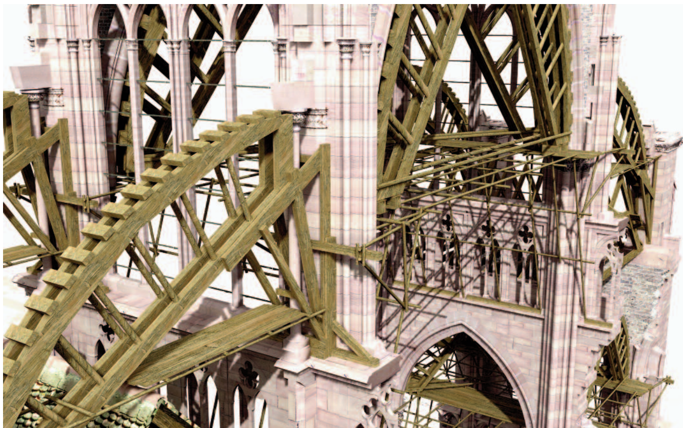
Figure 18. Restitution du principe d'échafaudage de la deuxième travée est de la nef au niveau des triforiums.
